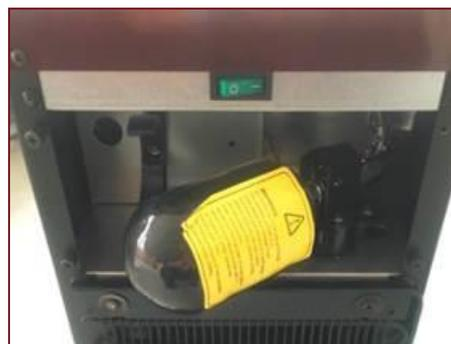
Installation de la cartouche CA06 à l'arrière de l'appareil.
